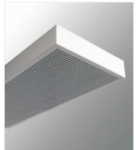
Passiver Kühlbalken KB-2 zum frei Abhängen von der Decke oder deckenbündig. Das Gehäuse ist RAL 9016 weiß pulverbeschichtet. Andere Farben sind möglich
